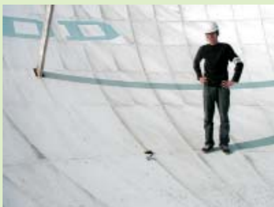
図3．携帯GPSを用いて、電波望遠鏡の表面で位置測定中
